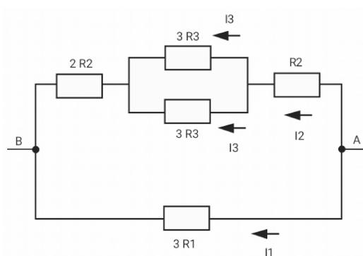
Нижний и верхний участки цепи соединены последовательно. Напишем для них равенство напряжений:
