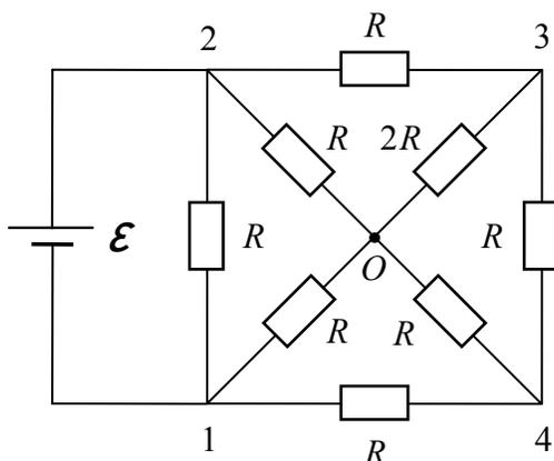
Перенумеруем вершины квадрата цифрами от 1 до 4 и найдём его общее сопротивление. Для этого преобразуем треугольник 2-3- $O$  в звезду с центром в точке  $O_1$ .
