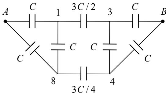
Далее преобразуем треугольник  $A$ –1–8 в звезду с центром в точке  $O_1$ . Так как ёмкости всех сторон треугольника одинаковы, звезда также состоит из одинаковых ёмкостей  $C_1$ . Значение  $C_1$  найдём, потребовав, чтобы при подключении источника напряжения к точкам  $A$  и 1 ёмкости треугольника и звезды совпадали. Получаем:
