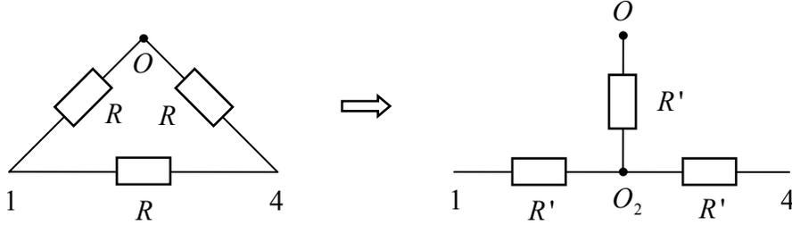
Далее преобразуем треугольник 1- $O$ -4 в звезду с центром в точке  $O_2$ . Так как сопротивления всех сторон треугольника одинаковы, звезда также состоит из одинаковых сопротивлений  $R'$ . Значение  $R'$  найдём, потребовав, чтобы при подключении источника за точки 1 и 4 сопротивления треугольника и звезды совпадали. Получаем:
