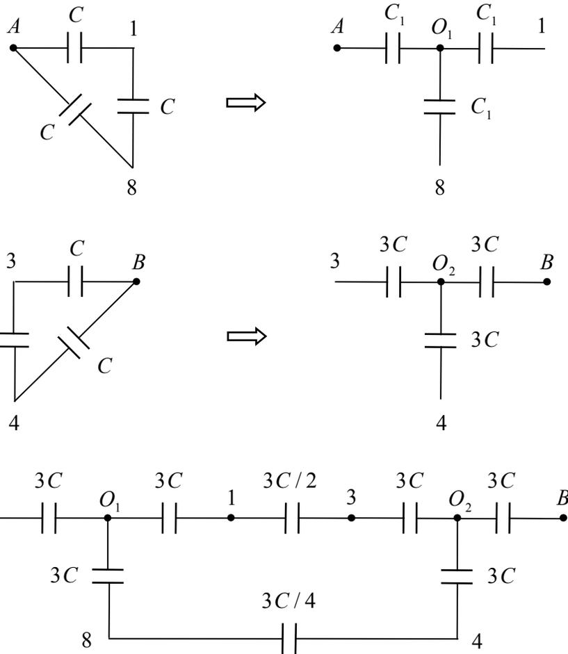
Ёмкости участков  $O_1-1-3-O_2$  и  $O_1-8-4-O_2$  равны соответственно  $3C/4$  и  $C/2$ . Так как эти участки включены параллельно, их общая ёмкость равна  $5C/4$ . Добавляя ещё две ёмкости  $3C$  на участках  $A-O_1$  и  $B-O_2$ , находим общую ёмкость звезды:
