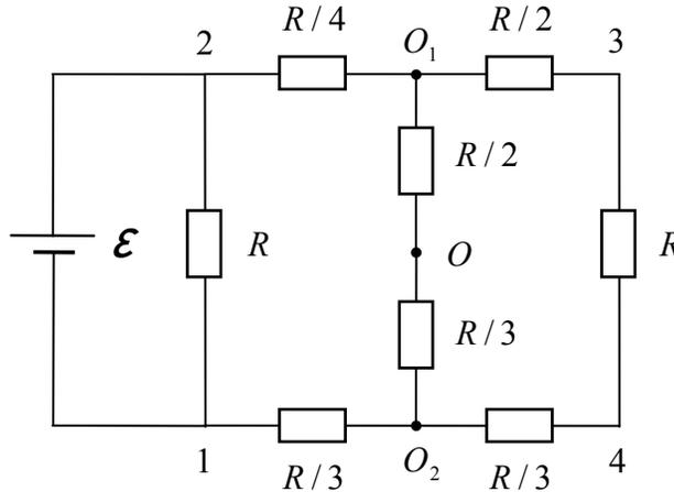
В результате получаем упрощённую схему, сопротивление которой легко вычисляется. Сопротивления участков  $O_1$ -3-4- $O_2$  и  $O_1$ - $O$ - $O_2$  равны соответственно  $11R/6$  и  $5R/6$ . Эти участки включены параллельно. Найдём их общее сопротивление  $R_A$ :
