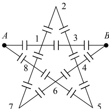
Перенумеруем узлы звезды цифрами от 1 до 8. Треугольники 1–2–3, 4–5–6 и 6–7–8 содержат два последовательно соединённых конденсатора. Их общая ёмкость равна  $C/2$ . Параллельно этой паре подключён ещё один конденсатор. Таким образом, общая ёмкость каждого треугольника равна  $3C/2$ . Поскольку треугольники 4–5–6 и 6–7–8 соединены последовательно, их можно заменить одним конденсатором ёмкостью  $3C/4$ . В результате получаем упрощённую схему.
