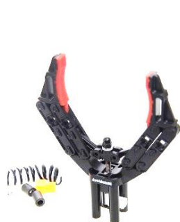
Рис.1. Захват робота двухпальцевый
