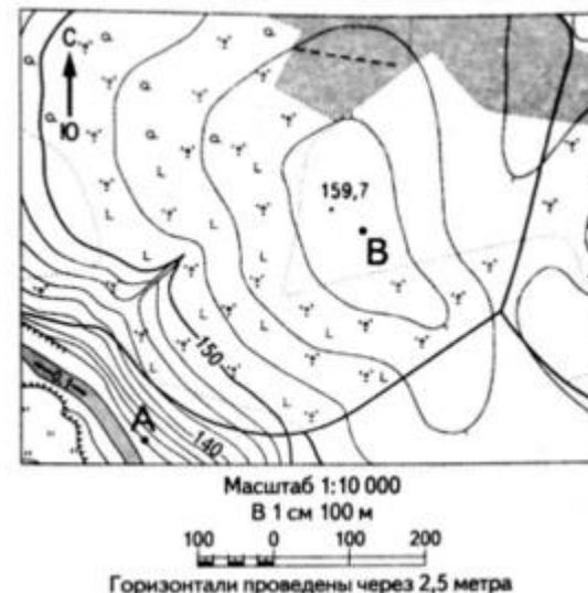
22 В бланке ответов № 2 укажите номер задания и Постройте профиль рельефа местности по линии А - В. Для этого перенесите основу для построения профиля на бланк ответов № 2, используя горизонтальный масштаб - в 1 см 50 м и вертикальный масштаб — в 1 см 10 м. Укажите на профиле знаком «X» положение дороги.
