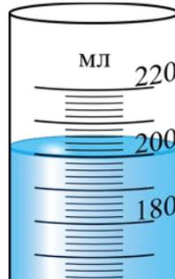
6) Пользуясь рисунком, определите цену деления измерительного цилиндра. Ответ приведите в кубических сантиметрах, округлив до целого числа. **(1 балл)**
