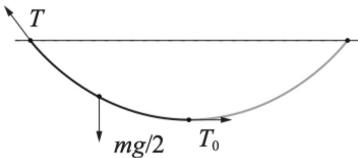
Зафиксируем расстояние между точками подвеса  $l = 85$  см. Рассмотрим условие равновесия половины цепочки (см. рис). Из равенства нулю суммы проекций сил на горизонтальное направление, следует, что сила натяжения в нижней точке  $T_0 = T_x$ .
