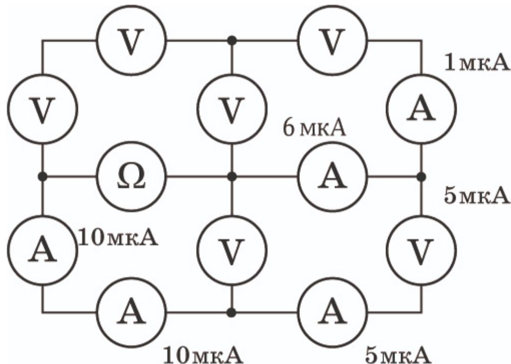
Показания омметра можно найти, разделив напряжение на внешней цепи между узлами *a* и *b*, на силу тока, протекающую через омметр:
