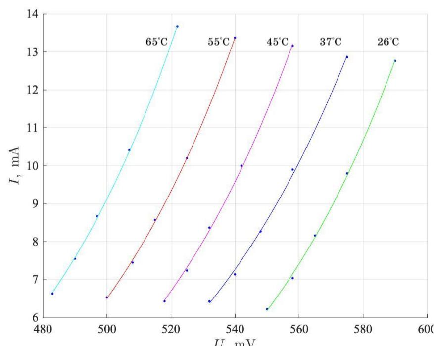
2<sup>3.50</sup> По результатам измерений постройте график (формат А5) зависимости напряжения на диоде  $U_x$  от температуры  $T$  при силе тока  $I_x = 10\text{mA}$ .
