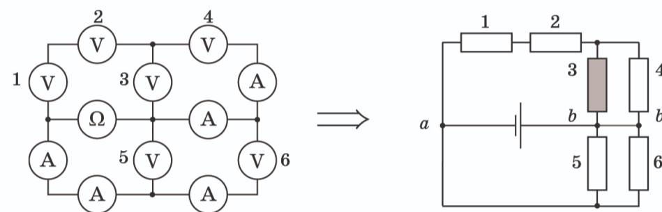
Здесь вольтметры обозначены как резисторы (цифрами 1, 2, 3, 4, 5 и 6 показано соответствие вольтметров резисторам), амперметры заменены идеальными проводниками, омметр обозначен как источник тока, выделены проводник, через который задан ток ( $bb'$ ), и вольтметр, на котором задано напряжение (№ 3).
