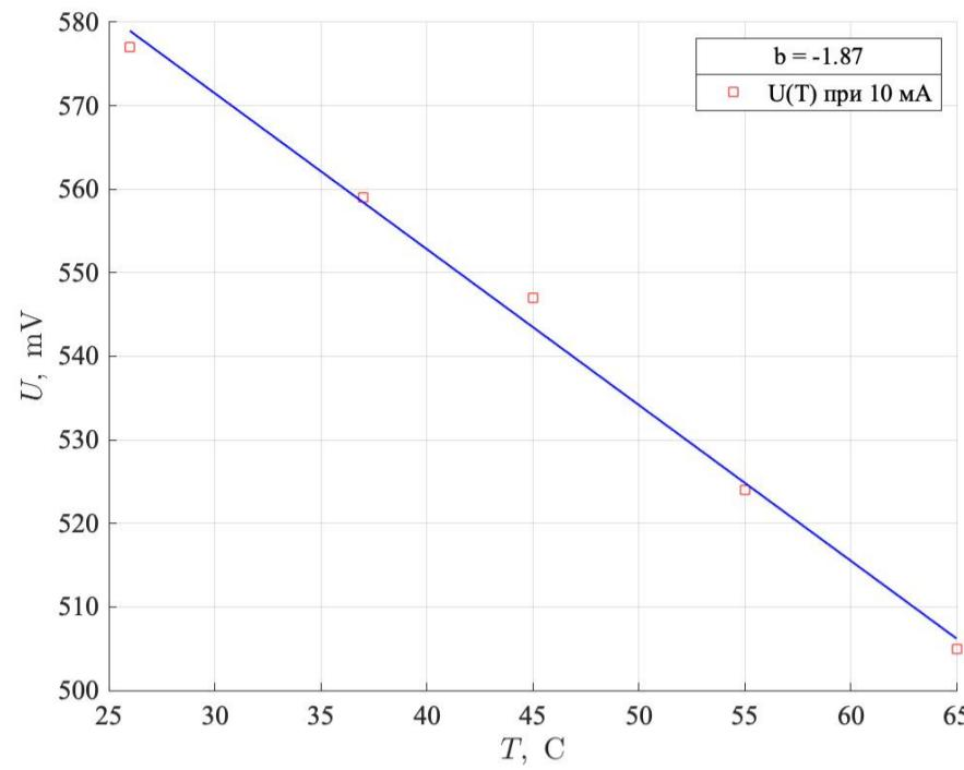
З<sup>1.50</sup> По графику зависимости  $U_x(T)$  определите ТКН диода.
