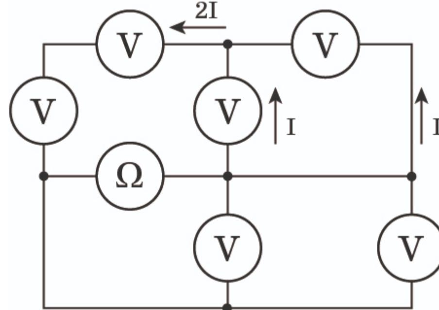
Так как напряжение между узлами  $b$  и  $a$  равно  $5IR_V$ , то через вольтметры № 5 и № 6 пойдут токи по  $5I$ .
