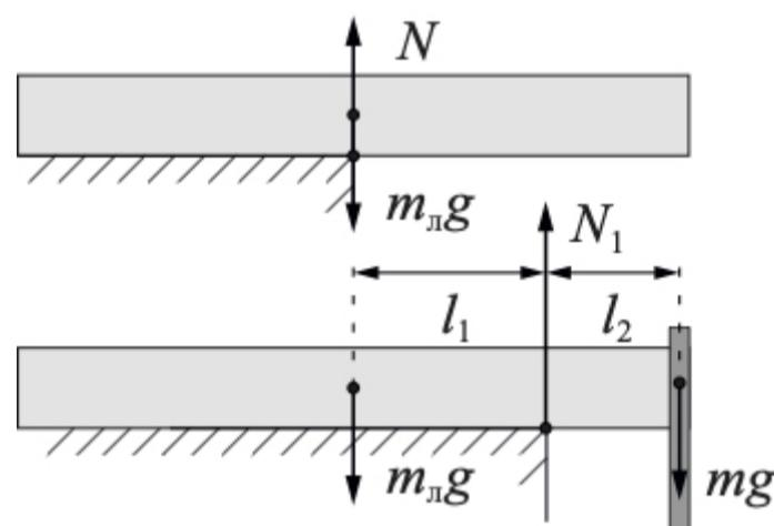
Запишем правило моментов относительно точки опоры:  $m_{\text{л}}gl_1 = mgl_2$ , где  $l_1$  и  $l_2$  – расстояния от центров тяжести рычага и цепочки до точки опоры.
