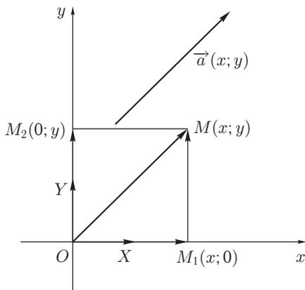
Рис. 420.  $\overrightarrow{OM} = \vec{a} = x\overrightarrow{OX} + y\overrightarrow{OY}$
