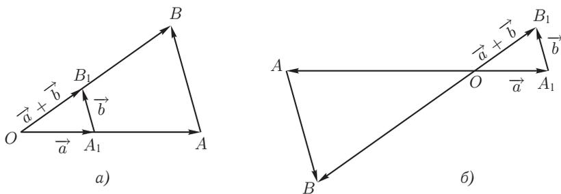
Рис. 410. а)  $k > 0$ :  $\overrightarrow{OA} = k\vec{a}$ ,  $\overrightarrow{OB} = k(\vec{a} + \vec{b})$ , б)  $k > 0$ :  $\overrightarrow{OA} = k\vec{a}$ ,  $\overrightarrow{OB} = k(\vec{a} + \vec{b})$
